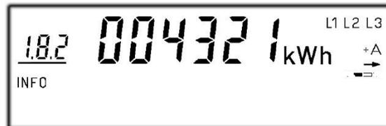
Variante Zweirichtungszähler: zusätzlicher Register 2.8.0
